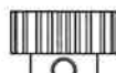
MA13 ×1 19Tピニオンギヤ 19T pinion gear 50355 19T Motormittel Pignon moteur 19 dents
